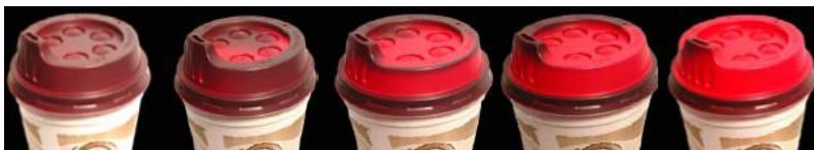
Gambar 5. Perubahan warna dari penutup pintar yang memperlihatkan peningkatan warna merah dari kiri ke kanan [45].
