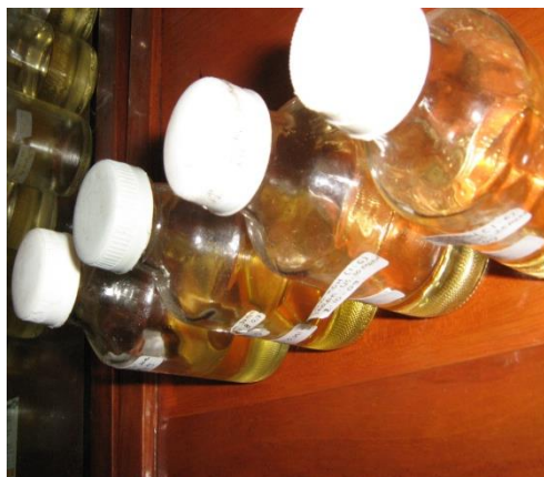
Gambar 13. Hasil biodiesel dari minyak jarak dengan ultrasonik
