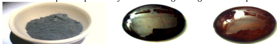
Gambar 3.2. (a) Serbuk Pewarna Hasil Kalsinasi Campuran \text{MnO}_2\text{-Fe}_2\text{O}_3 dengan Perbandingan 7:3, (b) Hasil Aplikasi pada Body Keramik dengan 11 g Glasir transparan, (c) Aplikasi pada Body Keramik dengan 15 g Glasir transparan.
