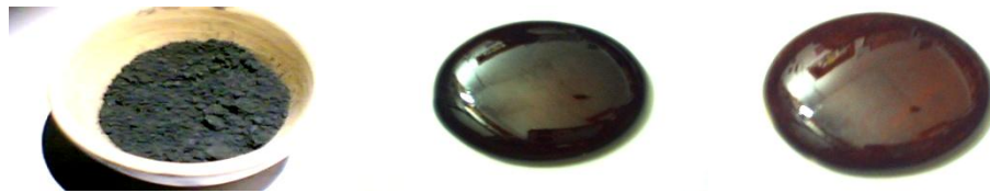
Gambar 3.1. (a) Serbuk Pewarna Hasil Kalsinasi Campuran \text{MnO}_2\text{-Fe}_2\text{O}_3 dengan Perbandingan 9:1, (b) Hasil Aplikasi pada Body Keramik dengan 11 g Glasir transparan, (c) Aplikasi pada Body Keramik dengan 15 g Glasir transparan
