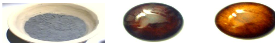
Gambar 3.4 (a) Serbuk Pewarna Hasil Kalsinasi Campuran \text{MnO}_2\text{-Fe}_2\text{O}_3 dengan Perbandingan 3:7, (b) Hasil Aplikasi pada Body Keramik dengan 11 g Glasir transparan, (c) Aplikasi pada Body Keramik dengan 15 g Glasir transparan
