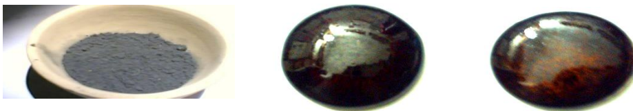
Gambar 3.3 (a) Serbuk Pewarna Hasil Kalsinasi Campuran \text{MnO}_2\text{-Fe}_2\text{O}_3 dengan Perbandingan 5:5, (b) Hasil Aplikasi pada Body Keramik dengan 11 g Glasir transparan, (c) Aplikasi pada Body Keramik dengan 15 g Glasir transparan
